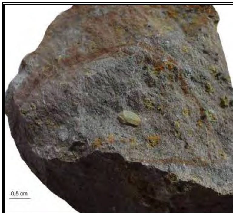
Abbildung 46: Auf dem Photo erkennt man deutlich die grünen Augite (besonders der ca. 0,5 cm große Kristall in der Mitte des Bildes ist schön ausgebildet) in der Rotbraunen Matrix des Augitporphyrs (Fundort oberhalb der Pauliner Hütte).
